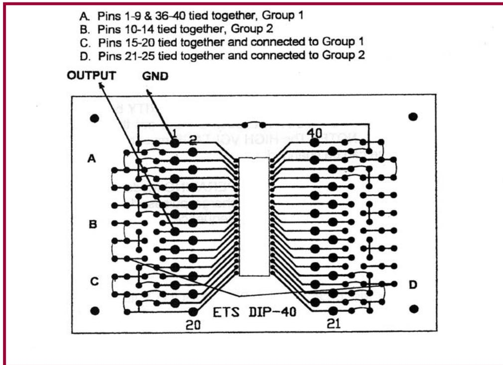
Figure 5.0-1: Programming IC Adapter Modules
